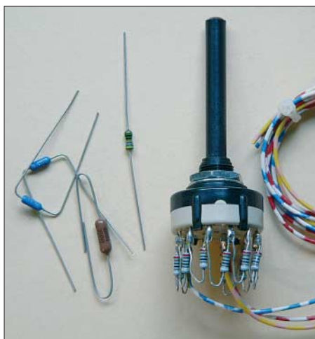
Bild 5: Die Widerstände einer Teilerstufe lassen sich direkt an den Schalter löten.
