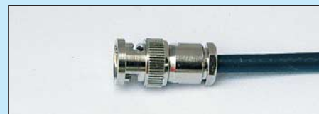
Bild 65: Ein kleiner Spalt ist zwischen Gehäuse und Mutter stehen zu lassen.
