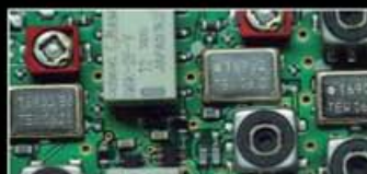
1. ZF: Drei Roofing-Filter bei 69,45 MHz
