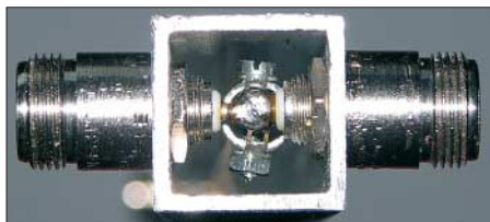
Bild 11: Anschluss eines Aluminium-Innenrohres an die Koaxialbuchsen
