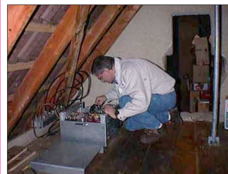
Abgleicharbeiten beim Digipeater DB0ASF (Aschaffenburg) am Link zu DB0GV Foto: DB0ASF
