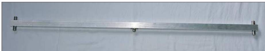
Bild 12: 2-m-Anpasstopf für vier Antennen nach dem Halbwellenprinzip
