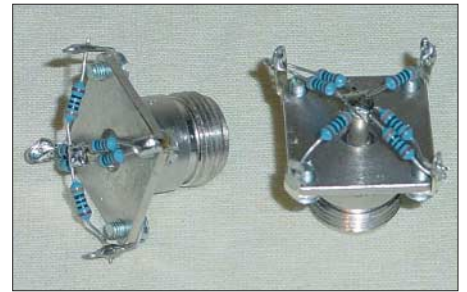
Bild 13: Selbstgebaute 50\text{-}\Omega -Abschlusswiderstände mit N-Buchse
