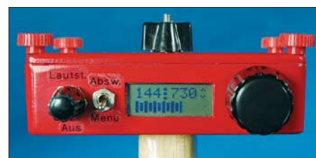
Bild 10: Der Empfänger im Aluminium-Druckgussgehäuse, dessen Deckel zum Batteriewechsel leicht abnehmbar ist
