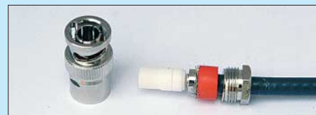
Bild 64: Die beiden Isolatoren halten den Mittelstift in ihrem Innern fest.
