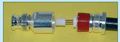
Bild 57: Den zweiten Isolator nicht vergessen.
