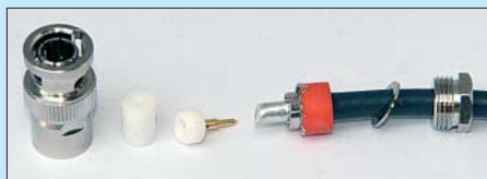
Bild 61: Nach dem Entwirren des Geflechts den Schaftkegel bis zum Mantel einschieben.
